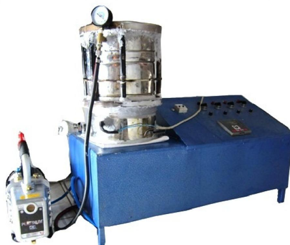
شکل ۱- سامانه سرخ کن تحت خلأ
