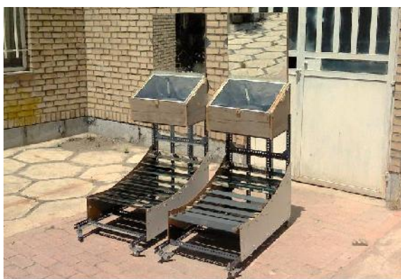
شکل ۱- اجاق‌های خورشیدی دو منظره در شرایط آزمایشی
