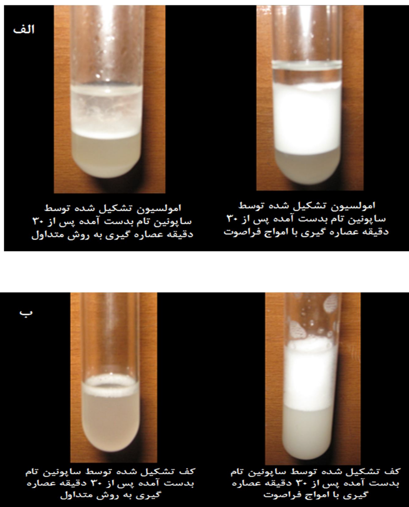
شکل 2- مقایسه وضعیت تشکیل امولسیون (الف) و تشکیل کف (ب) توسط ساپونین تام بدست آمده پس از 30 دقیقه عصاره-گیری به روش متداول و با امواج فراصوت
