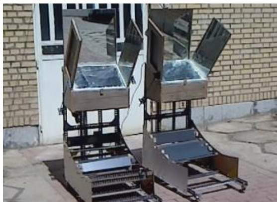
شکل ۲ - تصویر خوراک‌پزهای خورشیدی در هنگام آزمایش
