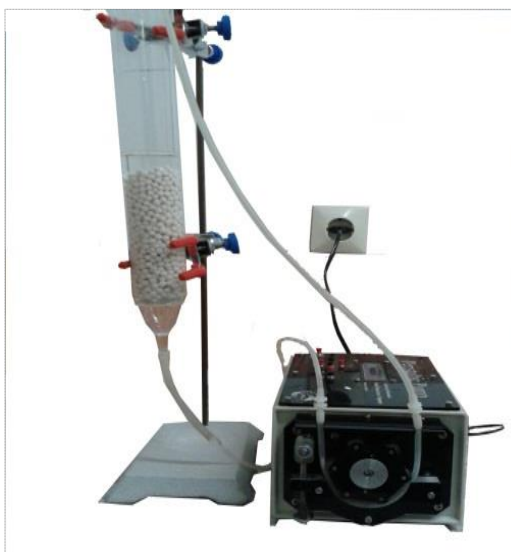
شکل ۲ - پمپ پرستالتیک و ستون شیشه‌ای حاوی آلومین با مخمر تثبیت شده
