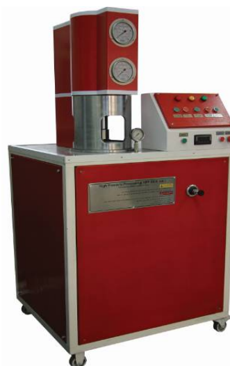
شکل ۱- دستگاه پرس ایزواستاتیک فشار بالا با قابلیت اعمال فشار هیدرواستاتیک ۶۰۰۰ بار
