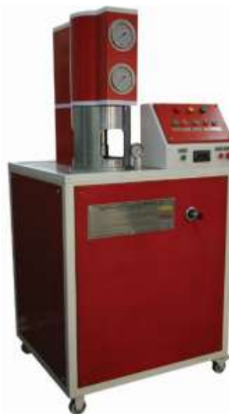
شکل ۱- دستگاه پرس ایزواستاتیک فشار بالا با قابلیت اعمال فشار هیدرواستاتیک ۶۰۰۰ بار
