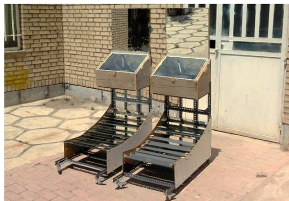
شکل 1- اجاق‌های خورشیدی دو منظره در شرایط آزمایشی
