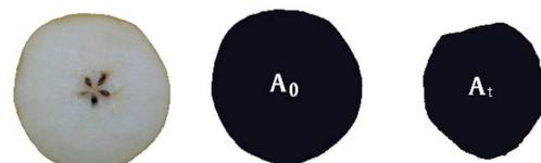
شکل ۴ - تصویر عکس برداری شده از نمونه اولیه برش گلابی در لحظه قبل از خشک شدن (چپ)، تصویر مساحت استخراج شده از نمونه اولیه (وسط) و تصویر مساحت استخراج شده از نمونه در حال خشک شدن در لحظه t (راست)
