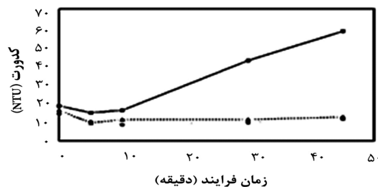
آزمایش ۷- زمان پالس ۵ ثانیه و شدت جریان الکتریکی ۰/۰۳ آمپر آزمایش ۸- زمان پالس ۵ ثانیه و شدت جریان الکتریکی ۰/۱ آمپر آزمایش ۹- زمان پالس ۵ ثانیه و شدت جریان الکتریکی ۰/۵ آمپر
